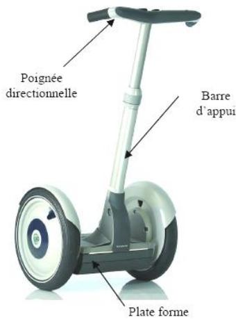
Le support de l'étude est le véhicule auto balancé Segway®. Il s'agit d'un moyen de transport motorisé qui permet de déplacer en ville un conducteur.
